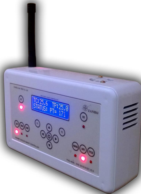
سامانه کنترل هوشمند کولرهای آبی با منطق PID فازی
